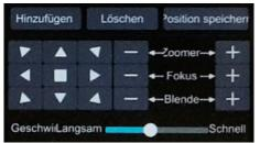
Mit der PTZ Schaltfläche können Sie über die RS-485 Schnittstelle mühelos PTZ-Kameras steuern. Sie können auch Preset-Positionen oder ganze Touren speichern und automatisch laufen lassen.
